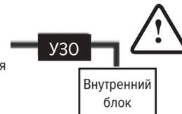
Рекомендуется установка устройства защитного отключения (УЗО) с номинальным током срабатывания не более 30 мА.
