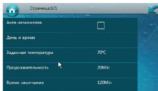
Если пользователь использует горячую санитарную воду непосредственно из бака ГВС, рекомендуется раз в неделю нагревать воду внутри бака при температуре выше 60°C, чтобы убить бактерии легионеллы.
