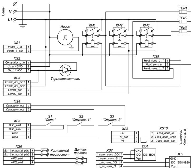
Схема электрическая принципиальная котла Tenko «Standart Digital+». Напряжение питания котла- 220В, Напряжение питания ТЭН -220В.
