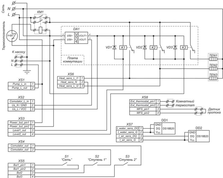
Схема электрическая принципиальная котла Tenko «Econom Digital». Напряжение питания котла- 220V, Напряжение питания ТЭН -220V.
