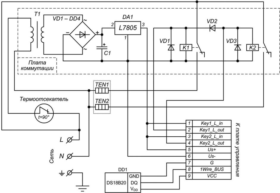
Схема электрическая принципиальная котла Tenko «Mini Digital». Напряжение питания котла- 220V, Напряжение питания ТЭН -220V.
