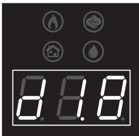
Рисунок 9 — Отображение давления в котле
