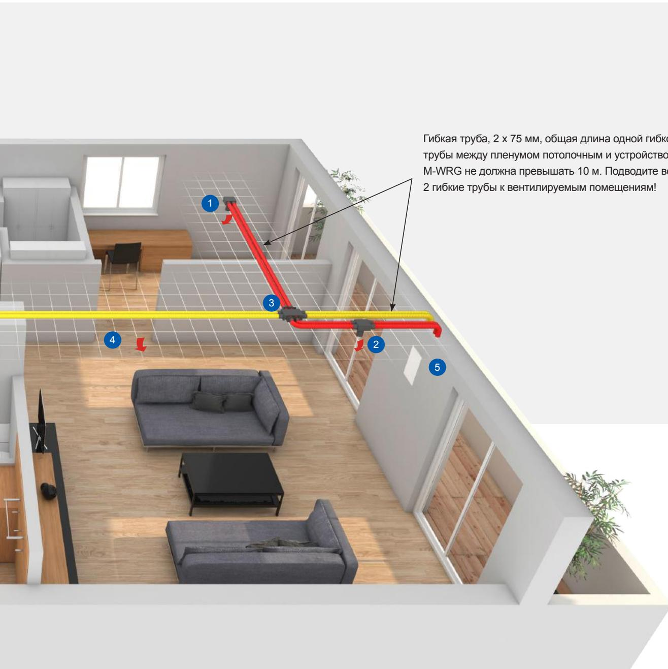
Гибкая труба, 2 x 75 мм, общая длина одной гибкой трубы между пленумом потолочным и устройством M-WRG не должна превышать 10 м. Подводите всегда 2 гибкие трубы к вентилируемым помещениям!
