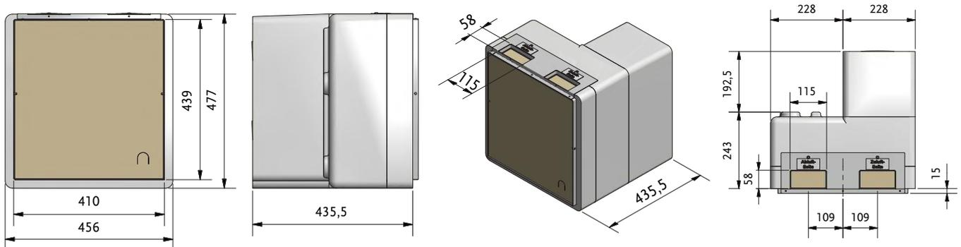
Размер 435,5 мм варьируется, можно сократить по длине в соответствии с конструкцией стены (вкл. внутреннюю и внешнюю штукатурку, а также изоляцию); мин. 243 мм толщины, макс. переменная (конструкции стен более 435,5 мм компенсируются более длинными вентиляционными трубами Арт. 5580)
