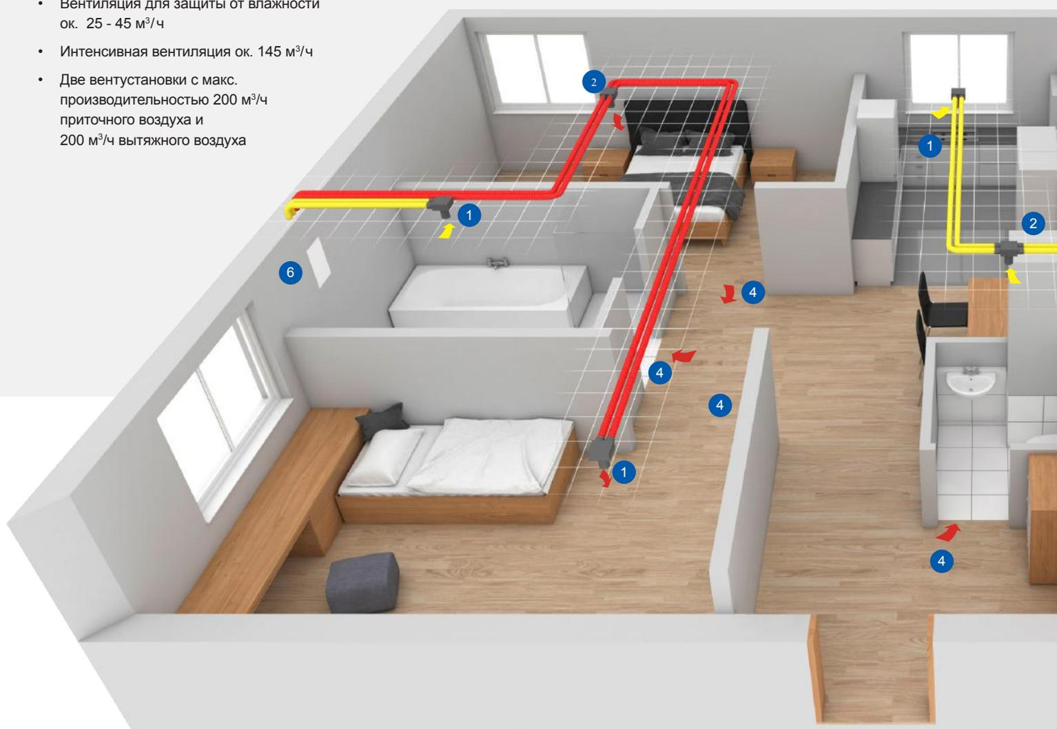
1 Пленум потолочный для подключения гибких труб 2 x 75 мм (или 63 мм) к DN 100
