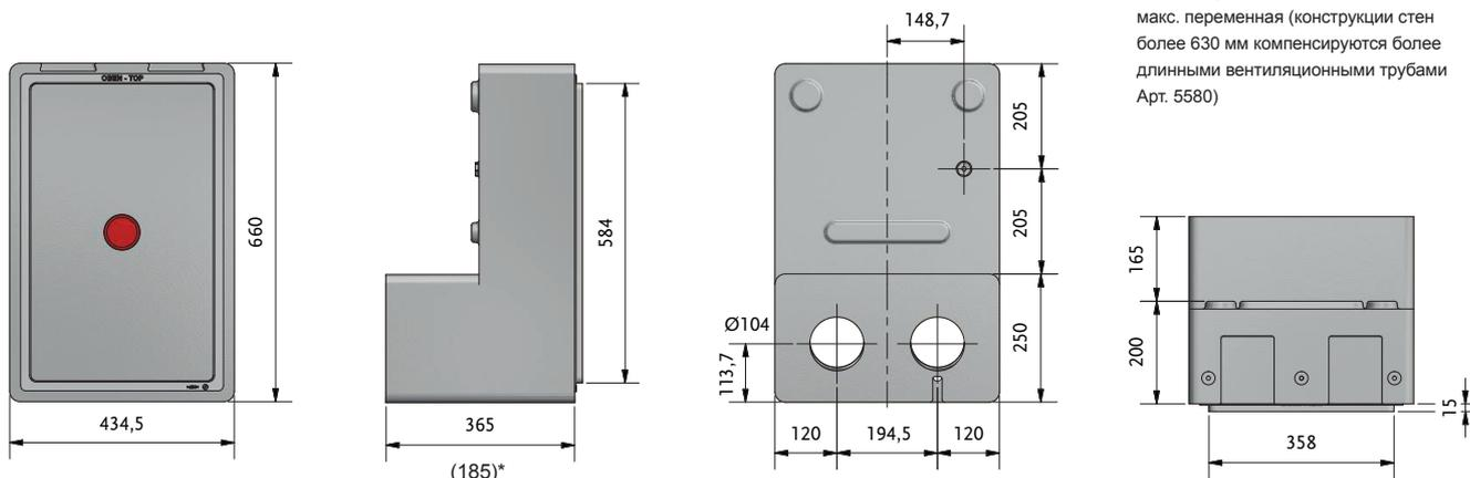
\* Глубина установки укорочена до минимального размера 185 мм на заводе-изготовителе
