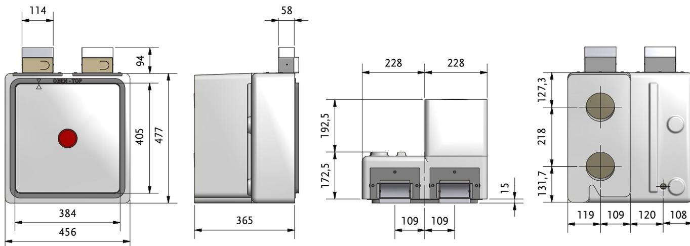
Глубина установки со штукатурной рамой мин. 187,5 мм (только при монолитной конструкции)
