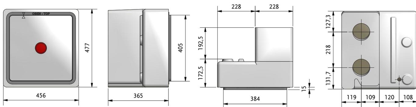
Глубина установки со штукатурной рамой мин. 187,5 мм (только при монолитной конструкции)
