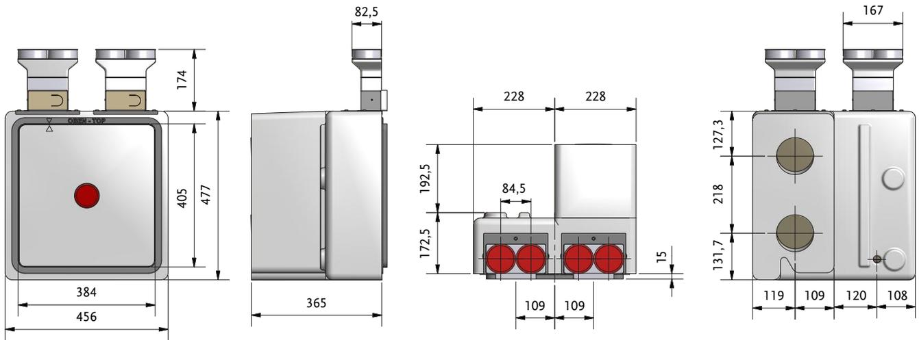
Глубина установки со штукатурной рамой мин. 187,5 мм (только при монолитной конструкции)
