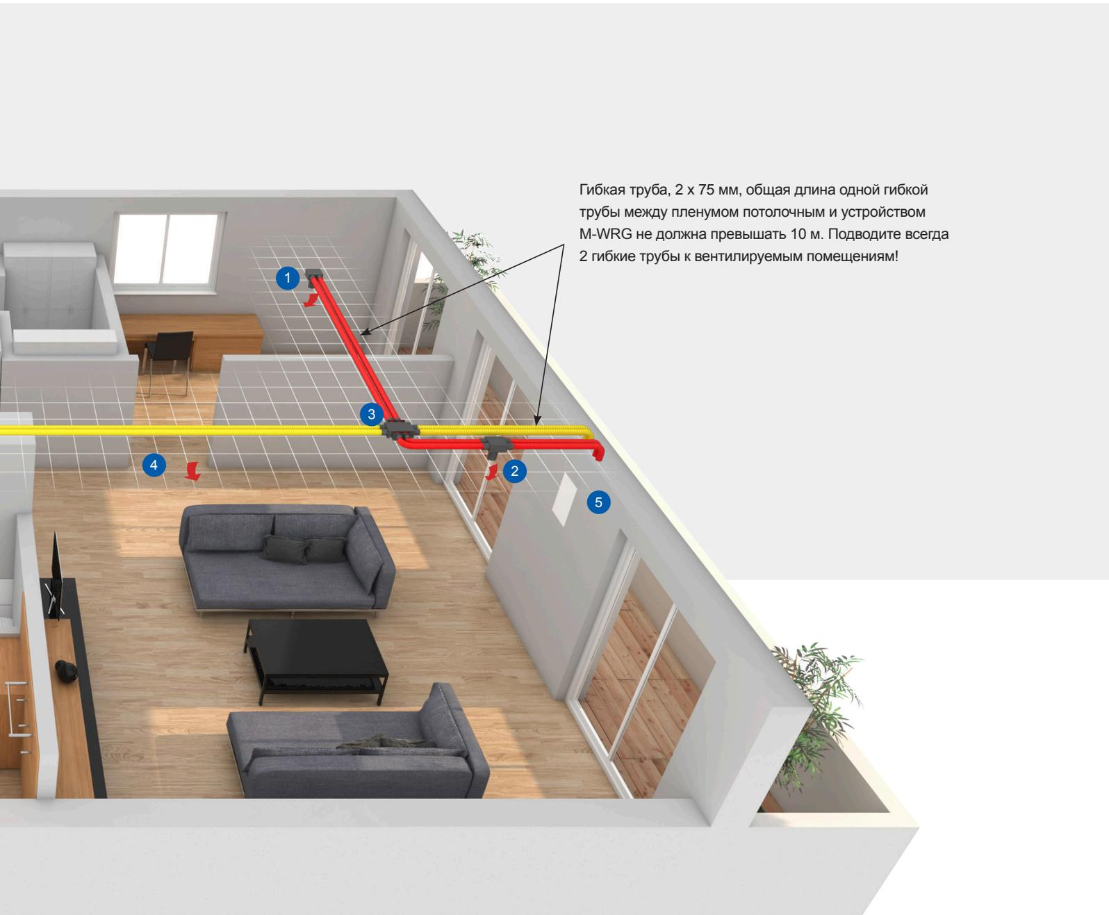
Гибкая труба, 2 x 75 мм, общая длина одной гибкой трубы между пленумом потолочным и устройством M-WRG не должна превышать 10 м. Подводите всегда 2 гибкие трубы к вентилируемым помещениям!
