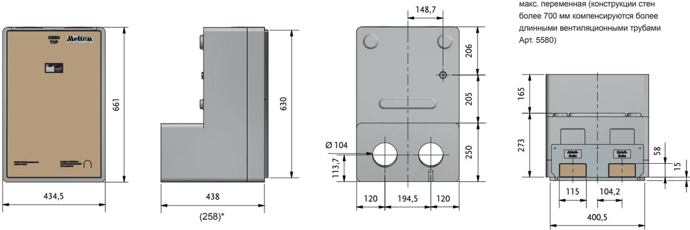
\* Глубина установки укорочена до минимального размера 258 мм на заводе-изготовителе
