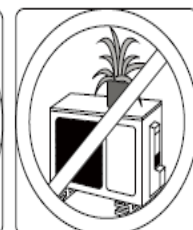
Пересвідчитись, що притік і витік повітря не заблоковані
