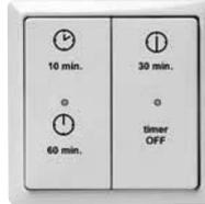
Светодиодные индикаторы панели управления Timer RF отображают только одну ошибку - отсутствие связи между вентиляционной установкой и панелью управления Timer RF.
