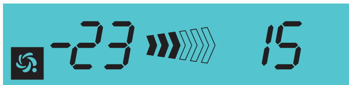
Рисунок 5. Вид ЖК-дисплея, когда прибор подключен к системе MagicAir и находится в режиме ручного управления
